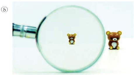
เมื่อมองวัตถุผ่านเลนส์เว้าแล้วเห็นภาพของวัตถุมีขนาดเล็ก
